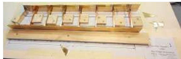
Verlötete Seitenteile und Querträger der Flutbrücke
