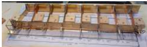
Flutbrücke mit Trägern für den Fußweg
