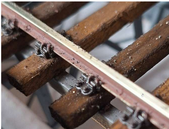
Schwelle, Schienenschuh und Gleisstrang
